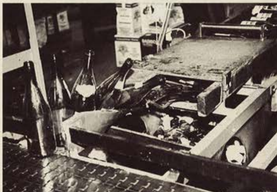
Die Flaschen-Sortier-Maschine erkennt jede Flasche nach Form und Farbe.
