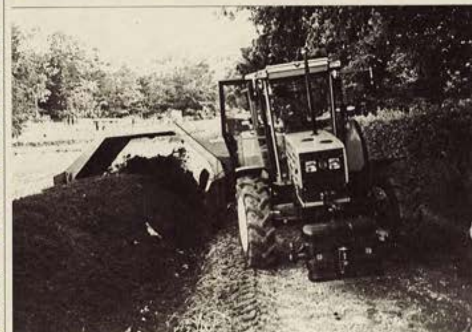
Mit der Kompostwendemaschine werden die Mieten immer wieder durchlüftet.
