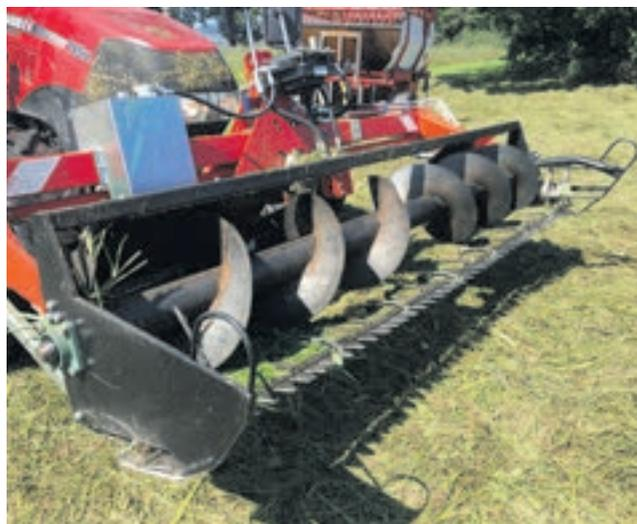
*Das neue Mähwerk besitzt ein Doppelmesser und zwei rotierende Schnecken. Dadurch wird das Ried schonend gemäht und Insekten werden weitgehend verschont.*
