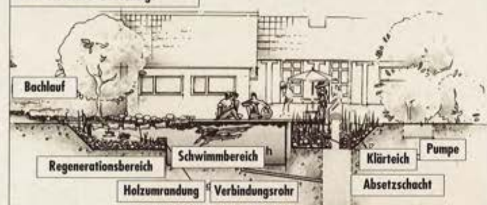
Schematische Darstellung des Funktionsprinzips einer Bioteich®-Badeanlage
