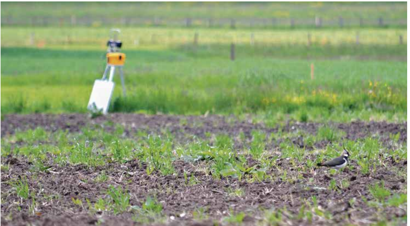
Die akustische Krähenabwehr im Nuoler Ried hält die schlaunen Rabenvögel in einem Umkreis von 250 m fern, um die Eier und Jungvögel der Kiebitze zu schützen, ohne die Kiebitzkolonie zu stören.
